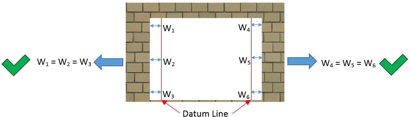
允許孔徑整體型材框架尺寸寬 10-15 毫米及高 10-15 毫米
